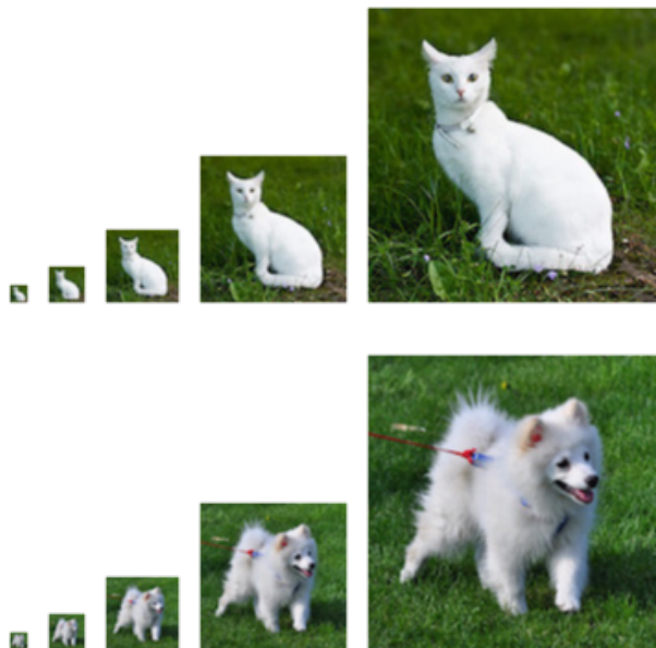
图2.6.1: 不同分辨率的图像 ( 10 \times 10 , 20 \times 20 , 40 \times 40 , 80 \times 80 , 和 160 \times 160 pixels)
