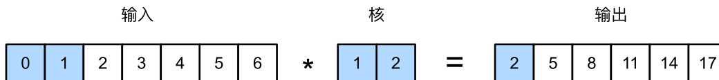
图15.3.2: 一维互相关运算。阴影部分是第一个输出元素以及用于输出计算的输入和核张量元素： 0 \times 1 + 1 \times 2 = 2
